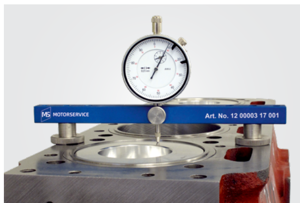
Рис. 2: Измерение выступа поршня
