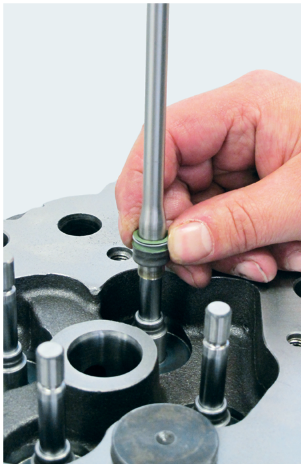
Рис. 2: Монтаж сальника стержня клапана
